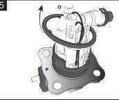
Remove the original sealing. Rimuovere la guarnizione originale.
