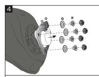
Remove bushings (R), washers (Q) and original nuts. Then remove the pump (O). Rimuovere boccole (R), rondelle (Q) e dadi originali. Successivamente rimuovere pompa (O).
